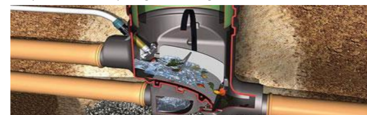
prikaz variante črpalnega in filtrirnega sistema deževnice
