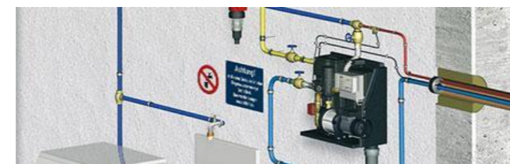
prikaz variante črpalnega in filtrirnega sistema deževnice
